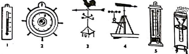
1. तापमापी (Thermometer) 2. दाबमापी (Barometer) 3. पवनफलक (Wind-Vane) या वायु दिशा मापक 4. पवनवेगमापी (Anemometer) 5. आर्द्रतामापी (Hygrometer) 6. वर्षामापी (Rain gauge)
